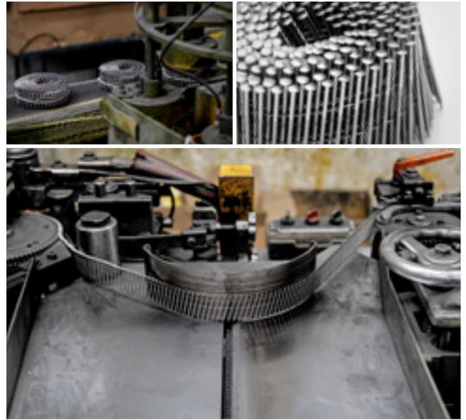
Ein untrennbarer Bestandteil der Maschinenproduktion ist auch das Bündeln der Nägel mit Draht, Papier oder Kunststoff. Diese Fertigung erfolgt mit den Maschinen ENKOTEC / BAUSSMANN und Zeus Techno. Durch diesen Arbeitsgang unterscheiden wir uns von vielen kleineren Herstellern, die lediglich lose geschüttelte Nägel liefern können.
